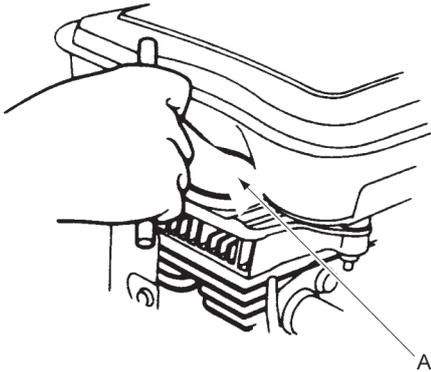
Controllare e pulire le candelette (A), se necessario sostituirle.
