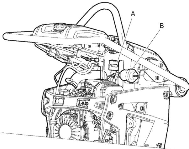
Controllare l'indicatore del filtro dell'aria (A). Se l'indicatore raggiunge il campo rosso, sostituire il filtro dell'aria.
