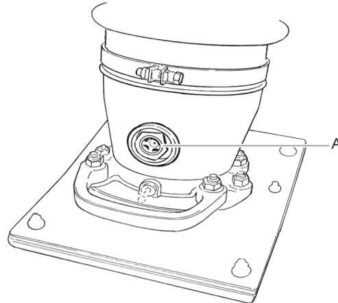
Controllare sull'indicatore di livello (A) il livello dell'olio della gamba.
