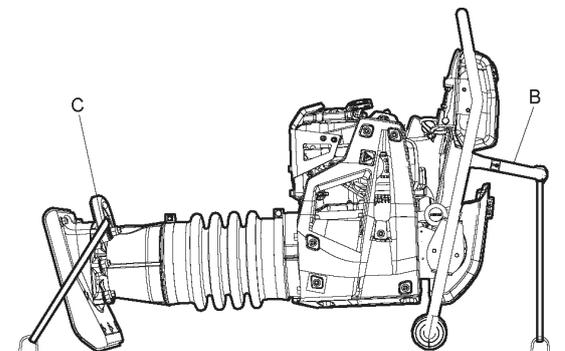
4. Per eseguire brevi spostamenti, la macchina può essere inclinata in avanti in modo che poggi sulle ruote di plastica dell'impugnatura. Sollevare tramite la maniglia di sollevamento inferiore (D) e far oscillare la macchina avanti e indietro.
