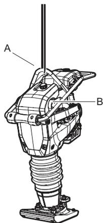
2. Il dispositivo di sollevamento deve essere dimensionato per conformarsi a tutte le normative vigenti. Prima di effettuare il sollevamento controllare che i componenti in gomma (B) e l'occhiello di sollevamento (A) siano attaccati correttamente e non danneggiati.
