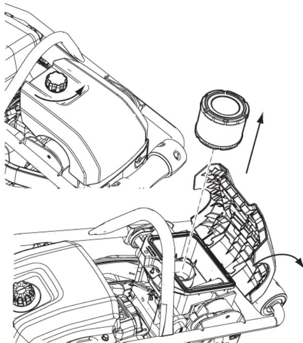
Controllare e pulire il filtro dell'aria (A).
